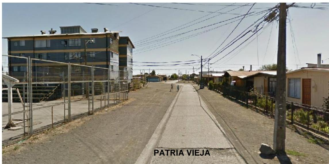
El pasaje tiene una longitud total de 1.300 m aproximadamente, mientras que el segmento estudiado tiene 268 m de longitud y un ancho entre líneas oficiales de 11 m. La materialidad de su calzada es de hormigón sin solera de 3 m de ancho, mientras que sus aceras son de tierra de 4 m de ancho.
