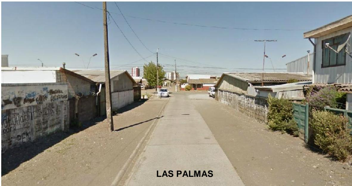
El pasaje tiene una longitud total de 500 m aproximadamente, mientras que el segmento estudiado tiene 176 m de longitud y un ancho promedio entre líneas oficiales de 11 m. La materialidad de su calzada es de hormigón de 3,5 m de ancho en un tramo y tierra compactada en otro, mientras que sus aceras son de tierra de 4 m de ancho.
