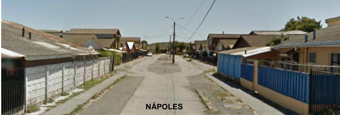
El pasaje tiene una longitud total de 1.500 m aproximadamente, mientras que el segmento estudiado tiene 140 m de longitud y un ancho entre líneas oficiales variable desde 10 m hasta 15 m. La materialidad de su calzada es de hormigón sin solera de 4 m de ancho, mientras que sus aceras son de pastelón con bandejón de tierra de 3 m de ancho.
